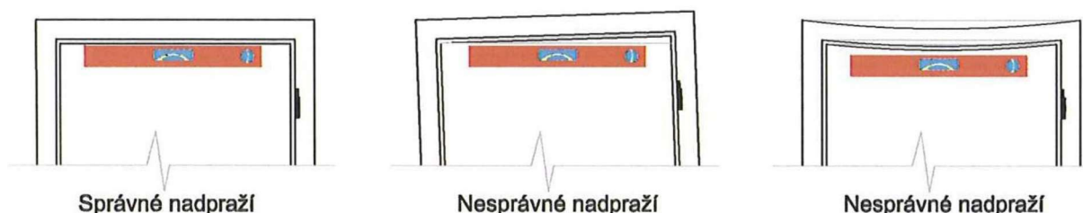
Obrázek 9. Ukázka správného a nesprávného usazení zárubně
