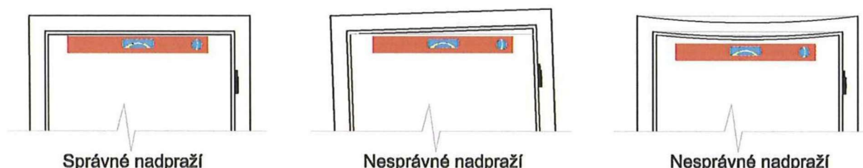
Obrázek 12. - Ukázka správného a nesprávného usazení zárubně.
