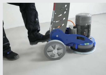
S podnožkou pro snadné naklápění stroje
